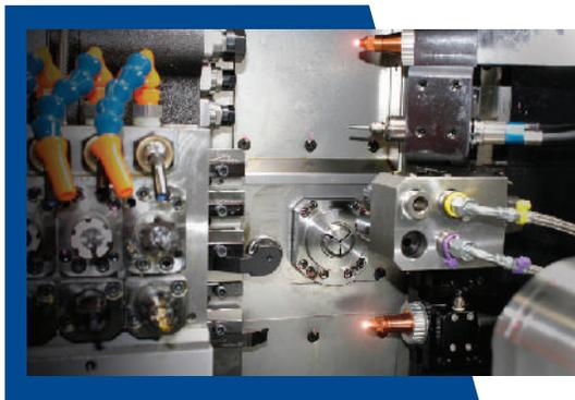
Les machines LaserSwiss Tsugami allient la puissance d'usinage Swiss CNC à la précision du laser. Les machines LaserSwiss sont de 20 mm ou 32 mm avec cinq à sept axes. Certains modèles incluent une tête de coupe laser à axe B et un second laser pour la soudure.
